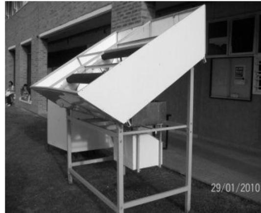
Figura 1a- Esquema del refrigerador solar por adsorción. Figura 1b- Un prototipo de refrigerador solar construido en la Universidad Nacional de General Sarmiento (año 2010) con capacidad para producir unos 6 a 10 kg de hielo diario (dependiendo del par refrigerante utilizado).
