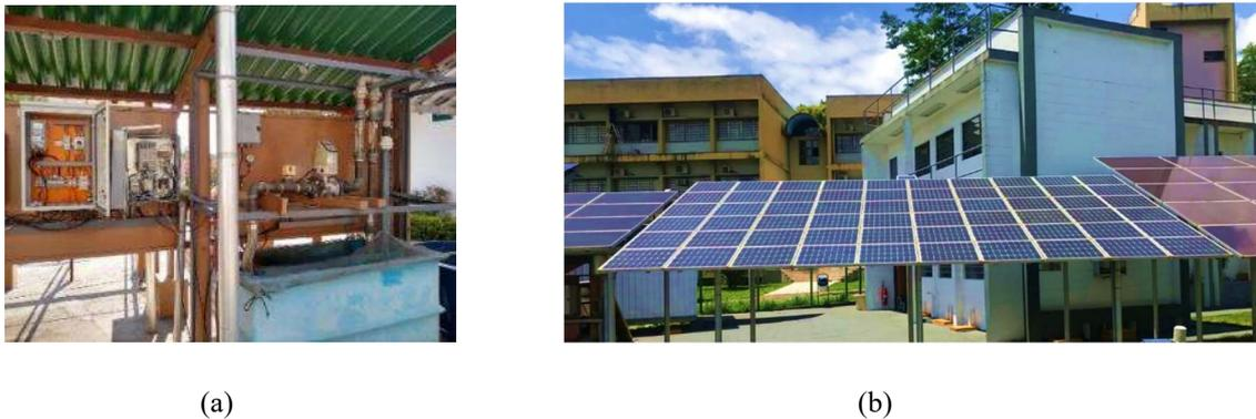
Figura 1 – (a) Bancada de ensaio para qualificação de Sistemas Fotovoltaicos de Bombeamento; (b) Gerador fotovoltaico utilizado.
