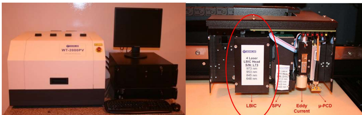
Figura 6 - (a) Equipamento WT-2000PV, da Semilab, para caracterização de células solares mediante a técnica LBIC e (b) detalhe do cabeçote com os lasers usados.
