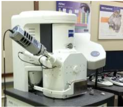
Figura 4 - Microscópio eletrônico de varredura da Zeiss, modelo EVO MA 15 (UTFPR, 2020).
