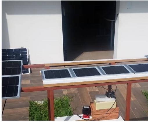
Figura 1 – Células de referência na estrutura de medição (fonte: do autor).
