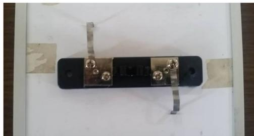
Figura 2 – Resistor shunt anexado na célula de referência (fonte: do autor).
