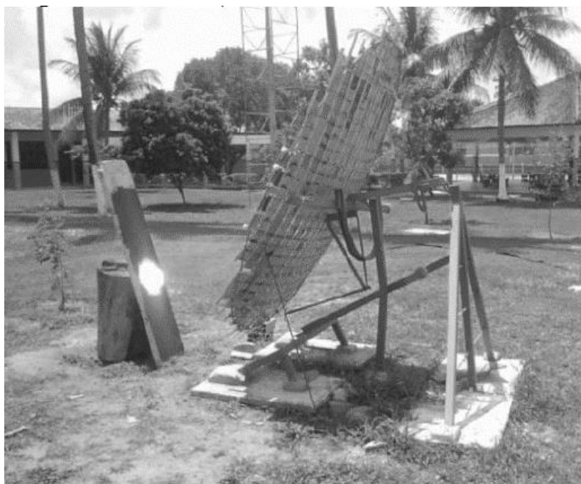
Figura 5 - Concentração do foco de luz no bloco de concreto Fonte: Aatoria Própria, 2013.
