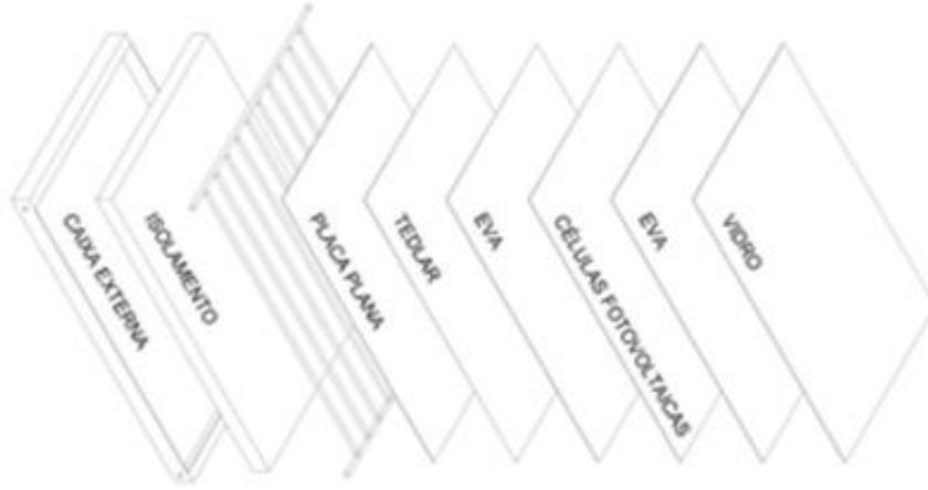
Figura 3 – Vista explodida de um PV/T adaptação de FERREIRA et al (2014)
