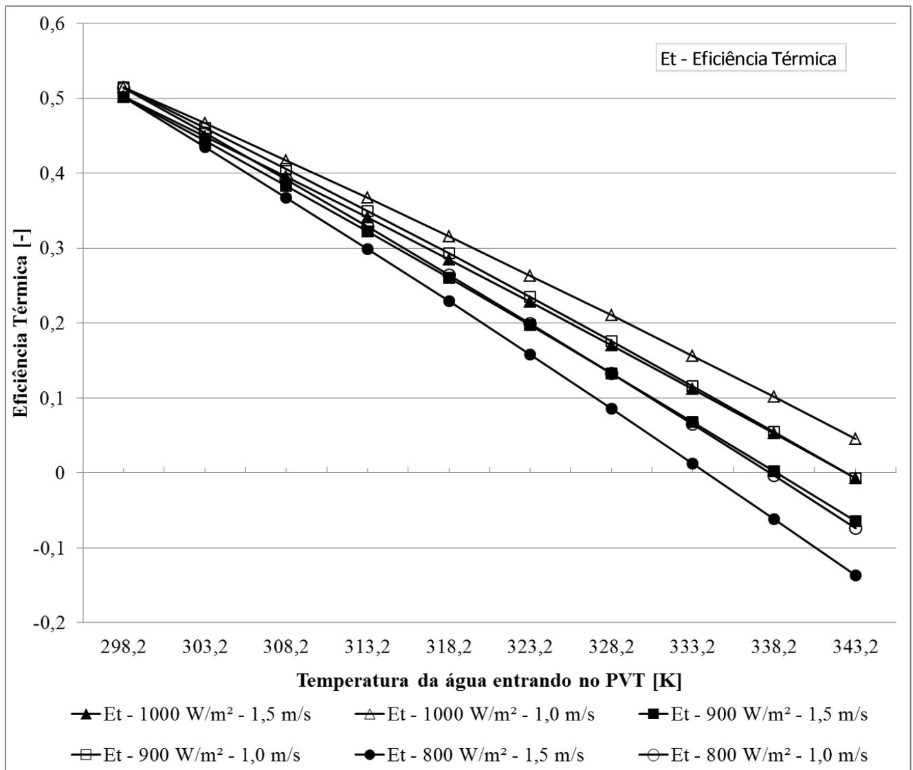
Figura 5 – Eficiência térmica em função da radiação solar e velocidade do vento.
