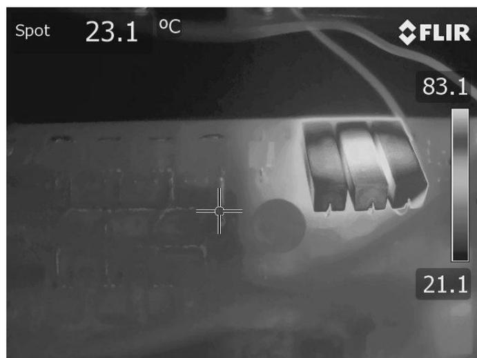
Figura 11 – Termografia do circuito do inversor em pleno funcionamento.
