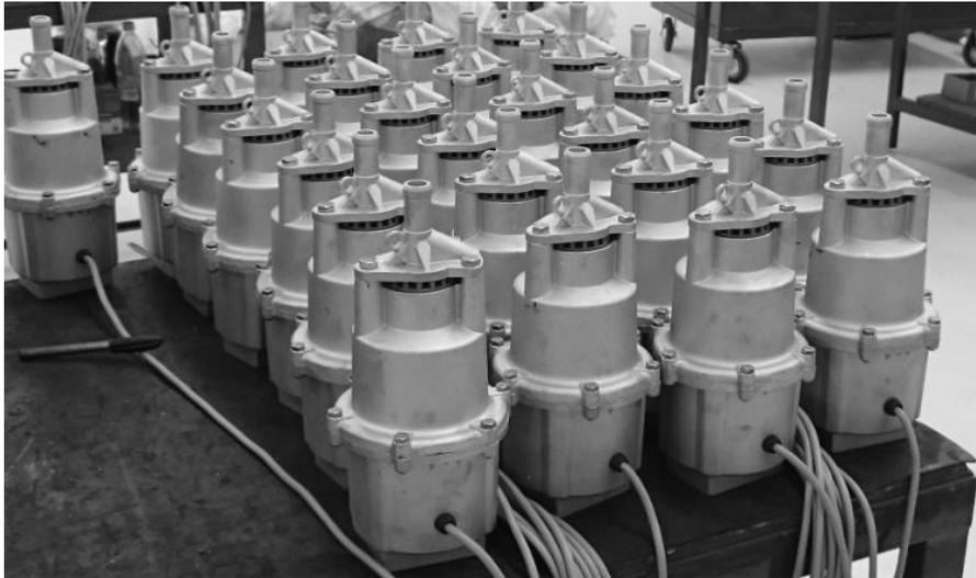
Figura 2 – Bombas submersas vibratórias.
